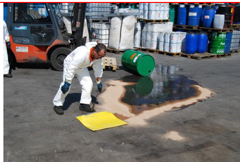
4. Tekočino se posuje s praškom, ki veže nase nevarno tekočino
